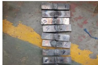
Gambar 11. Spesimen hasil pengelasan dan heat treatment
