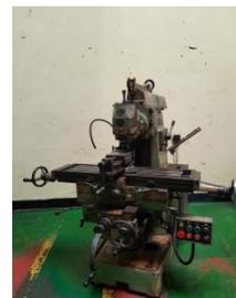
Gambar 4. Mesin frais vertikal
