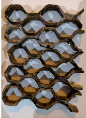
Gambar 1. Struktur honeycomb heksagonal dari bilah bambu sebelum direkatkan dengan face plate
