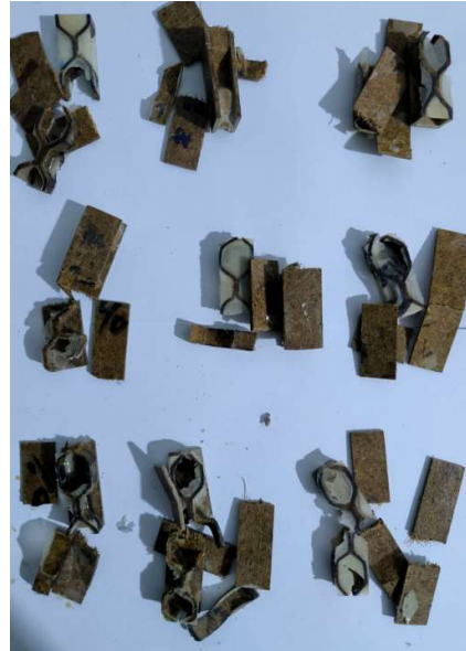
Gambar 5. Bentuk kerusakan spesimen setelah pengujian impact, disusun menurut fraksi volume face plate
