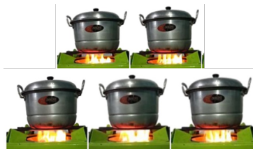
Gambar 8. Penyalan briket sarang lebah pohon pakis selama 2 jam 30 menit
