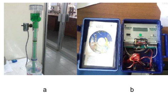
Gambar 2. (a) Irrrometer pengukur suction (b) datalogger perekam data suction dan data kejenuhan tanah
