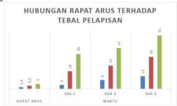
Gambar 6.Grafik Rapat Arus Terhadap Tebal Pelapisan
