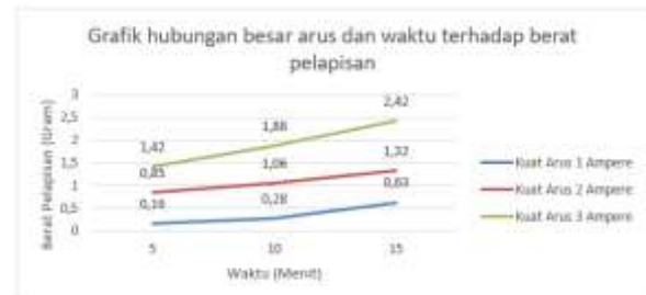
Gambar 5. Grafik hubungan antara arus dengan berat pelapisan nikel
