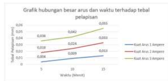
Gambar 7.Grafik Hubungan Besar Arus Dengan Ketebalan Lapisan Nikel
