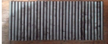
Gambar 7. Spesimen Uji Lelah ( fatigue )
