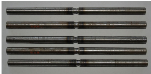
Gambar 9. Spesimen Uji Lelah
