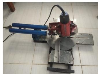
Gambar 5. Mesin Pemotong dengan rell Penggeser
