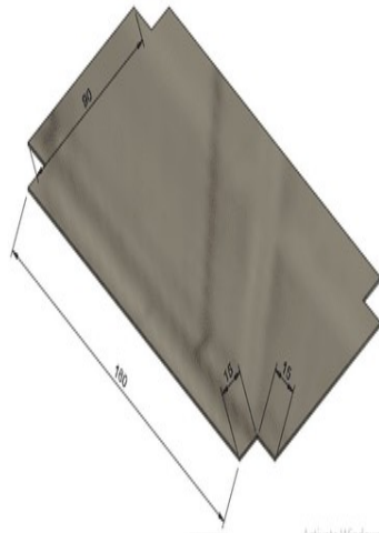
Gambar 8. Proses pemotongan plat stainless untuk duduk kompor mawar
