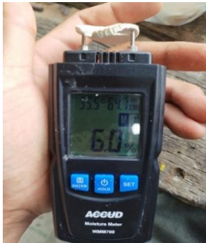
Gambar 9. Proses pengukuran kadar air setelah dikeringkan
