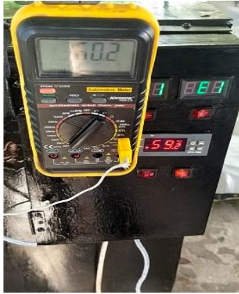
Gambar 4. Validasi Suhu Ruangan menggunakan Automotive meter (Krisbow Kw06-276)
