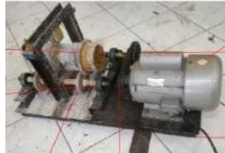
Gambar 8. Mesin cetak centrifugal casting yang sudah dirakit
