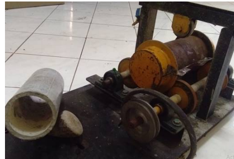
Gambar 7. Proses perakitan mesin cetak centrifugal casting
