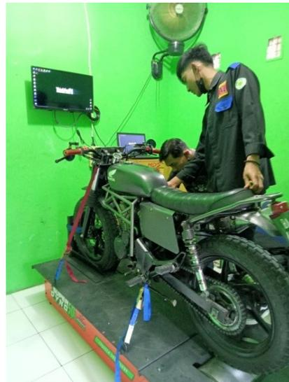
Gambar 9. Proses penghitungan daya dan torsi dengan dyno tes
