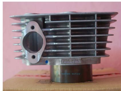
Gambar 3. Blok silinder
