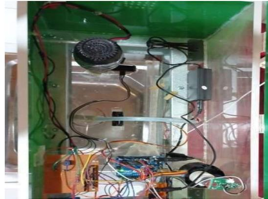
Gambar 6. Perakitan kontrol otomatis pada westafel
