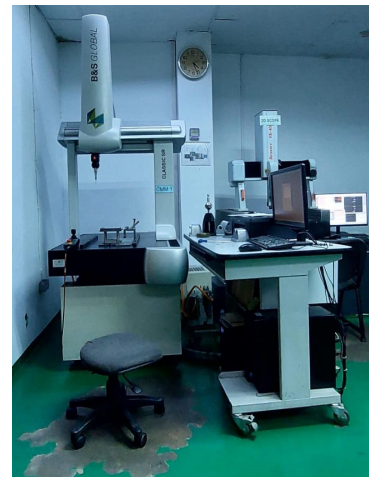
Gambar 2. Mesin CMM 4D untuk Pengukuran Dimensi
