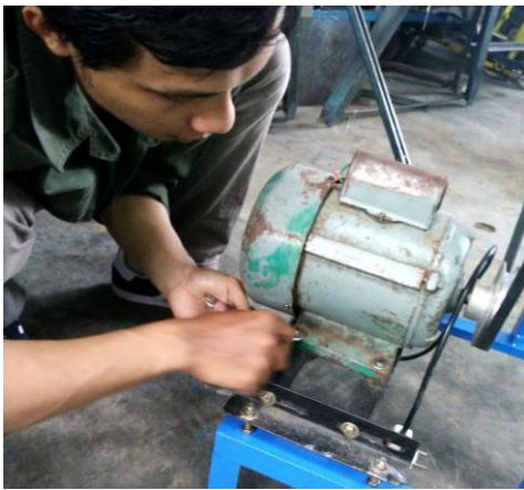
Gambar 23 Penyetelan kedudukan motor
