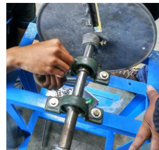
Gambar 22 Pemasangan Poros ke Bearing
