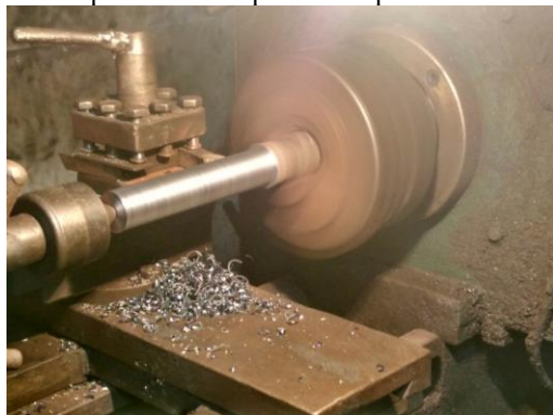
Gambar 19 Proses pembubutan poros
