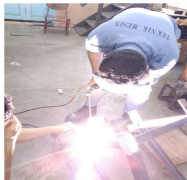
Gambar 14 Pengelasan Besi siku
