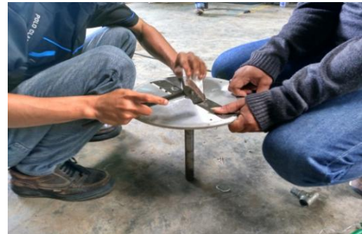
Gambar 20 Pemasangan dudukan pisau ke poros
