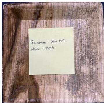
Gambar 10. Hasil Uji Coba 2 Suhu 150°C dengan waktu 1 menit
