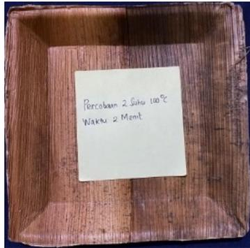
Gambar 8. Hasil Uji Coba 1 Suhu 100°C dengan waktu 2 menit
