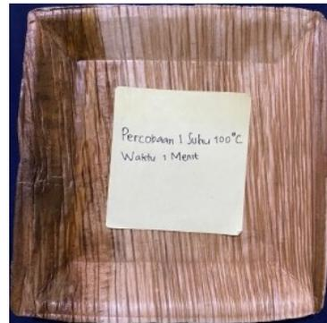
Gambar 7. Hasil Uji Coba 1 Suhu 100°C dengan waktu 1 menit
