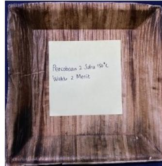
Gambar 11. Hasil Uji Coba 2 Suhu 150°C dengan waktu 2 menit
