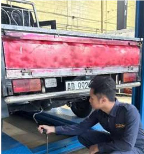
Gambar 2. Pengujian Emisi Gas Buang Kendaraan
