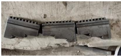
Gambar 3. Komponen pencekam mesin bubut
