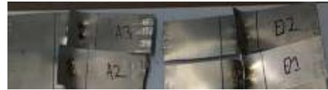
Gambar 3. Spesimen Plat *Stainless Steel* 316L
