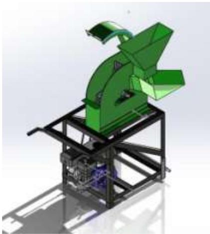
Gambar 7. Desain mesin penepung multifungsi untuk pakan ternak
