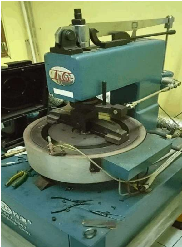
Gambar 6. Alat Uji Koefisien Gesek dan Laju Aus
