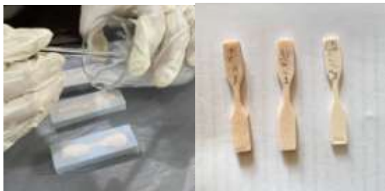
Gambar 5. Proses Pencetakan Hidroksiapatit dan Silika
