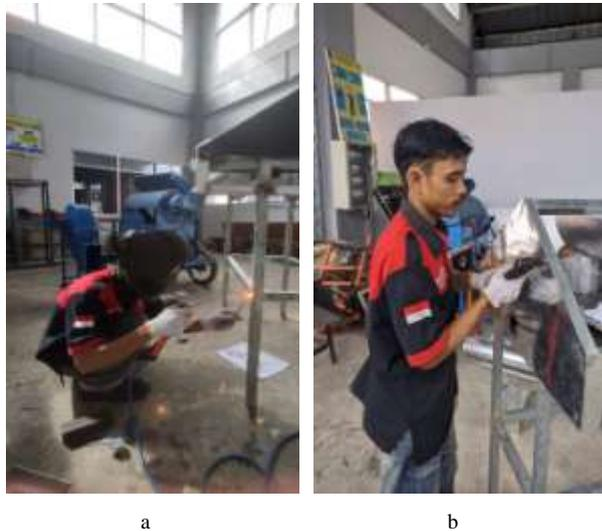
Gambar 3. Pembuatan alat pengering kopi, a. Pengelasan rangka; b. Pemasangan dinding
