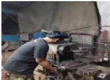
Gambar 5. Proses Pembuatan Poros
