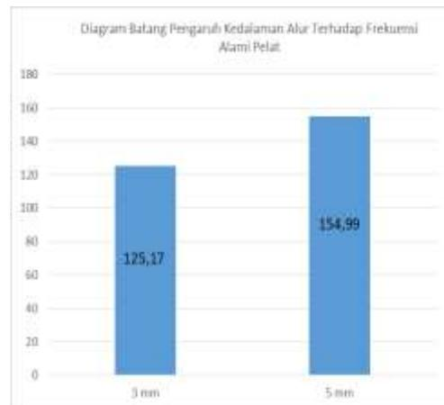
Gambar 6. Pengaruh Kedalaman Alur Terhadap Hasil Frekuensi Alami Pelat Uji dengan Kondisi Batas Jepit-Jepit
