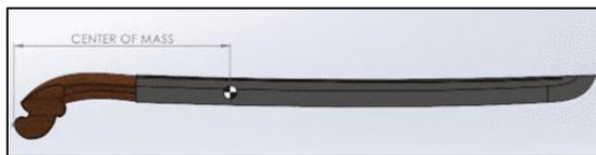
Gambar 5. Pengukuran Manual CoG
