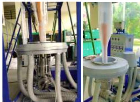
Gambar 17. Proses peniupan plastik LLDPE dan campuran bahan antibakteri menjadi lembaran plastic film
