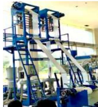
Gambar 1. Mesin *blown film*
