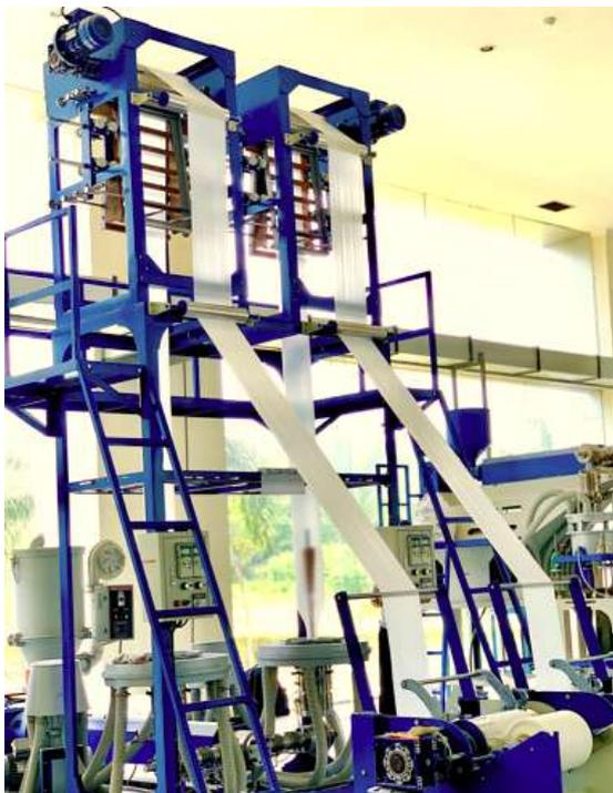
Gambar 19. Proses pengerolan dan penggulangan plastik LLDPE dan campuran bahan antibakteri menjadi lembaran plastic film
