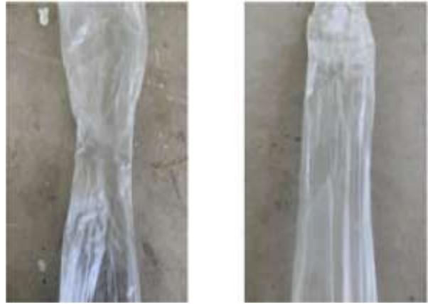
Gambar 22. Cacat *Shrinkage*
