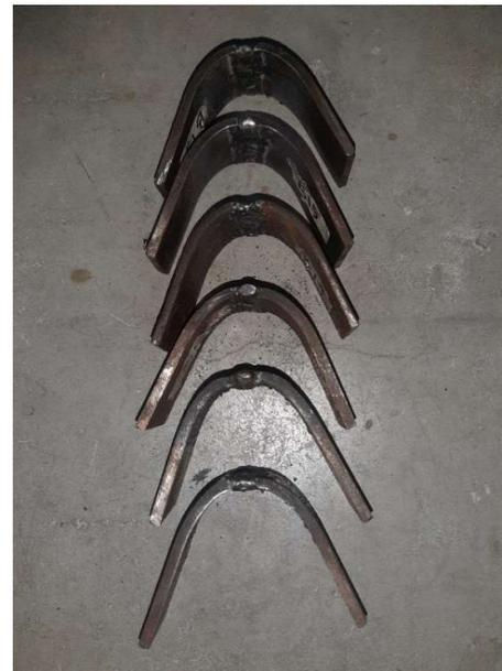
Gambar 5. Spesimen Hasil Uji Bending
