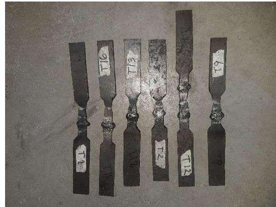
Gambar 4. Spesimen Hasil Uji Tarik
