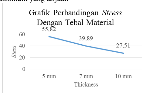
Gambar 9. Grafik Hubungan Perbedaan Tebal Material dengan Tegangan Maksimum
