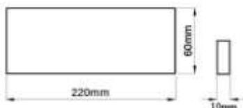
Gambar 6. Dimensi spesimen *side bend*
