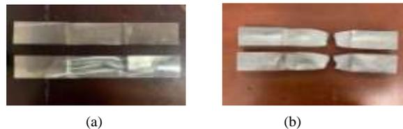
Gambar 7. (a) Sebelum Spesimen *Tensile* diuji (b) Setelah Spesimen *Tensile* diuji
