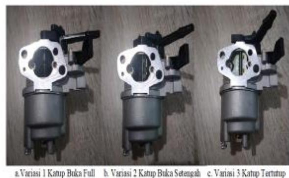
Gambar 3. Variasi *Choke Valve*
