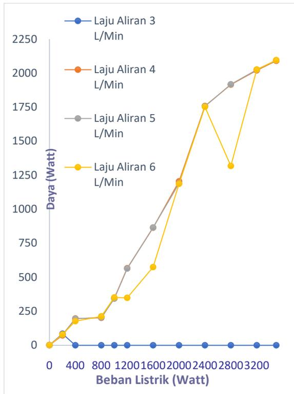
Gambar 7. Grafik Fungsi beban terhadap Daya Listrik pada variasi Choke Valve yang dibuka penuh
