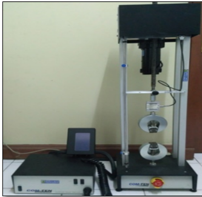
Gambar 3. Mesin uji retak COM-TEN 95T series 5 K
