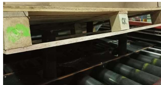
Gambar 8. Posisi plat penyangga dibagian bawah pallet sebelum perbaikan
