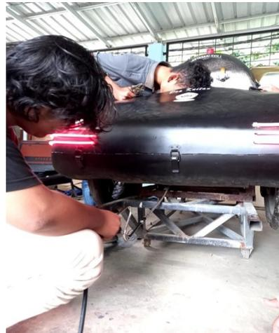
Gambar 6. Proses pemasangan *probe sensor* pada knalpot mobil Antasari Evo I
