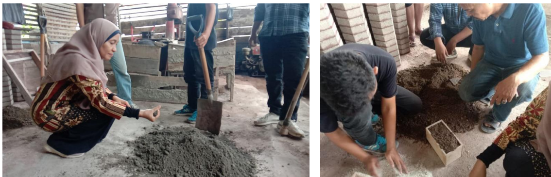
Gambar 6 Proses pengecekan kondisi air campuran dan pencetakan paving block
