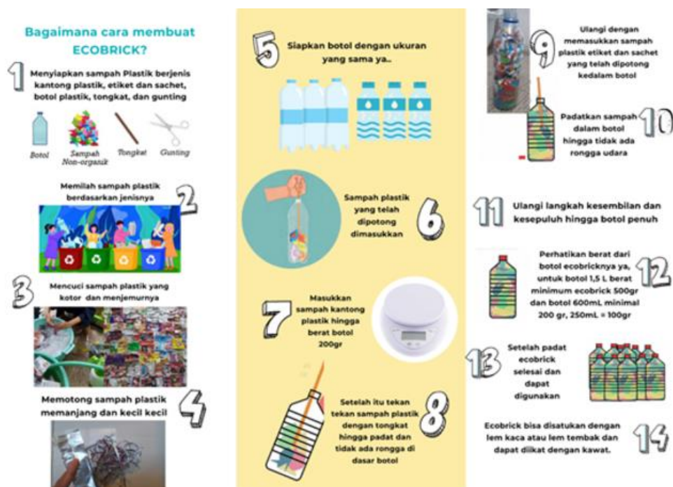
Gambar 1. Tahapan pembuatan ecobrick [4]
