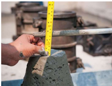
Gambar 1 . Pengujian Slump Beton
