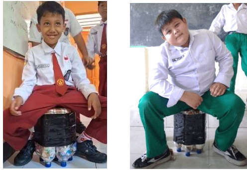
Tahap uji coba kekuatan dan fungsional dari kursi ecobrick yang dilakukan oleh beberapa siswa dengan duduk pada kursi
