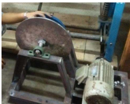
Gambar 10. Assembling unit pencacah pada rangka
