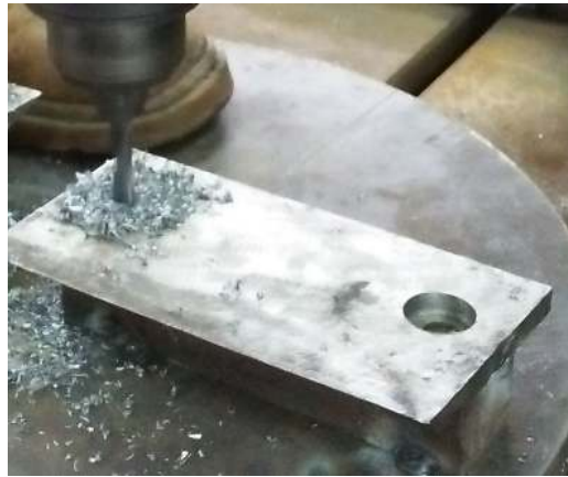
Gambar 7. Proses pembuatan pisau pencacah
