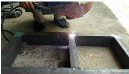
Gambar 9. Pembuatan rangka bawah
