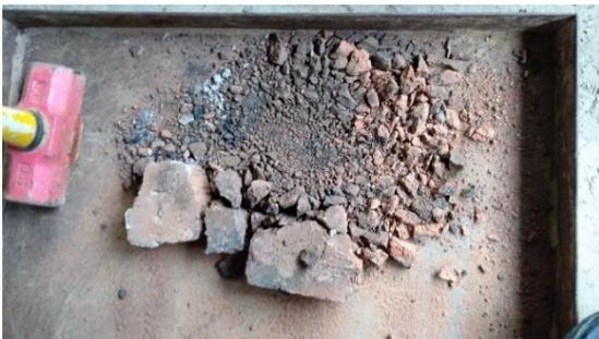
Gambar 3. Proses Pembuatan Serbuk Bata Merah
