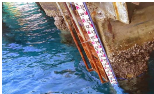
Gambar 3. Rambu Ukur Pasang Surut
