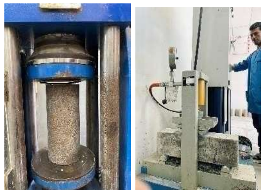
Gambar 4. Alat Uji Kuat Tekan dan Lentur Beton
