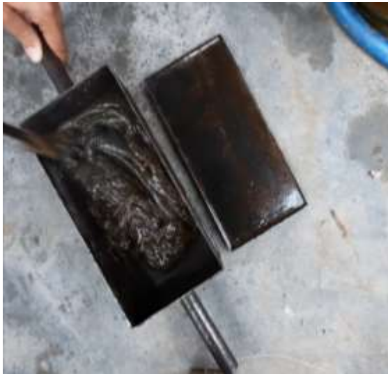
Gambar 4. Pencetakan Paving Block
